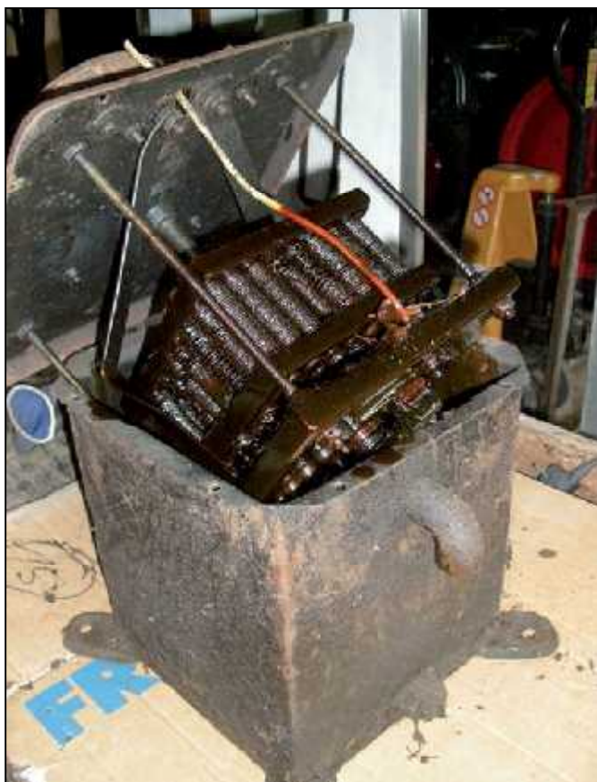
Der Anlaufstrom-Begrenzer vor der Bearbeitung ...
