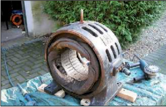
Das Innenleben des Motors ist ausgebaut . . .
