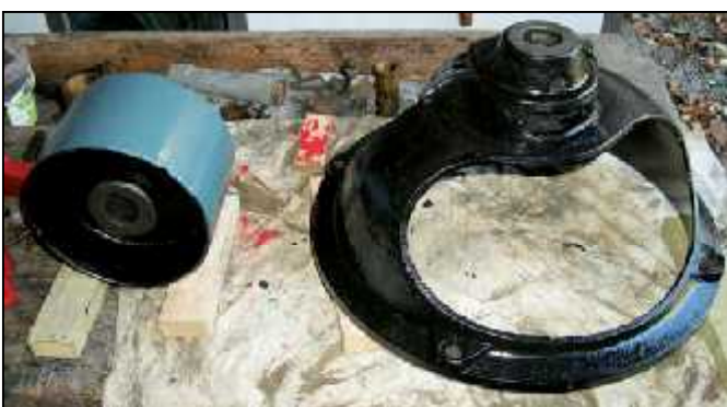
Fertig sind die Riemenscheibe und das Vorderteil des Motors
